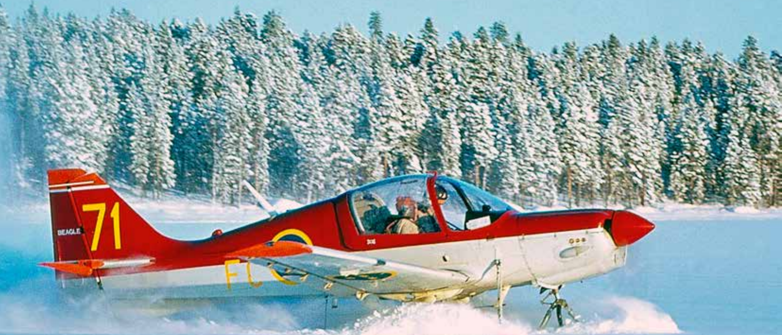
Beagle B 125 Bulldog G-AVLN, märkt FC-71, genomfördes på Vidselbasen vintern 1970. Som synes på bilden fungerade skidorna utmärkt i lössnö vid start och landning.
