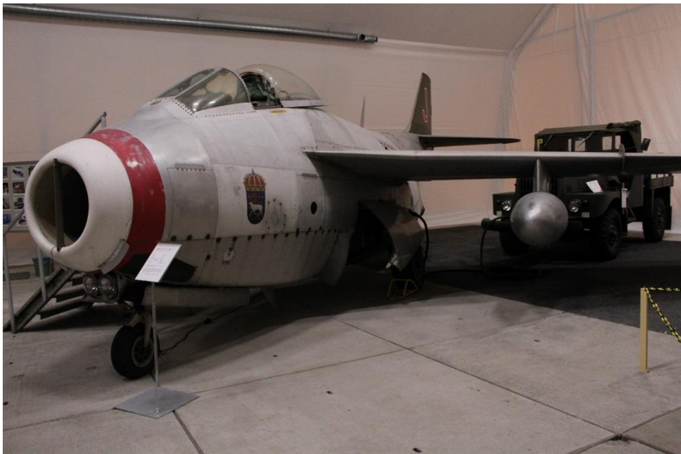
Flygmuseets S 29C Tunnan och startbilen som användes både för att strömförsörja flygplanet och för att bogsera flygplan med. Båda har tjänstgjort under sin aktiva tid på F 21:s spaningsdivision Urban Röd.
